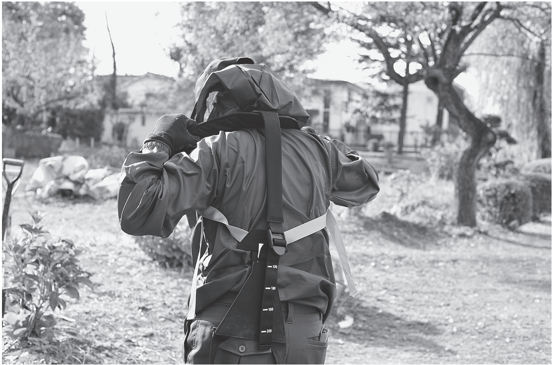
アシストスーツのうちの一つ、「マッスルスーツ Soft-Power EASY-LIFT」。その効果を実感し、除草作業のたびに進んで利用する会員もいる
